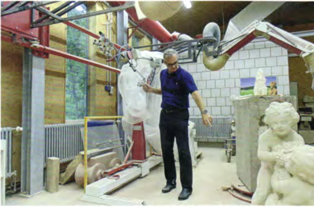
Das berührungslose Laser-Punktiergerät ermöglicht die material-schonende und rationelle Anfertigung handwerklicher Kopien und Reproduktionen nach Originalvorlagen und Modellen.
